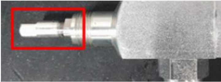
Figure 46 : Tige de vanne d'arrêt complètement ouverte
