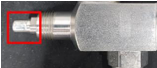
Figure 47 : Tige de vanne d'arrêt complètement fermée
