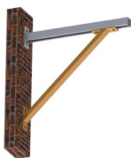
Renfort pour console - vue en situation
